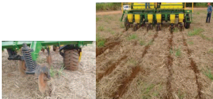
Figura 1. Disco de corte de palhada e abertura de sulco de plantio. Fotos: Evandro C. Mantovani, semeadora-adubadora COP CA, da Marchesan, 2012.
