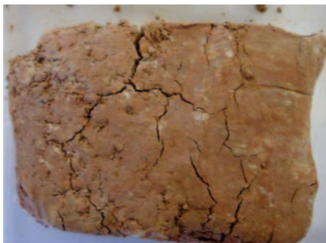
Figura 2. Aspecto da amostra de solo (AC-P05) no final do primeiro ciclo de umedecimento e secagem (Foto gentilmente cedida por Brivaldo Gomes de Almeida).
