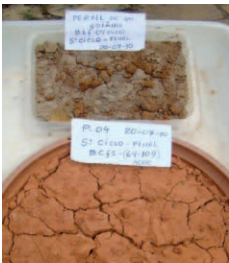
Figura 4. Aspecto da amostra de referência (bandeja retangular superior) e da amostra do perfil AC-P04 (BCf1) (bandeja circular inferior) no final do quinto e último ciclo de umedecimento e secagem. Nota-se material plíntico (agregados com cor vermelha e estáveis > 2 mm) na amostra de referência e alguns poucos agregados avermelhados, pequenos, de consistência dura a muito dura, contidos numa matriz de consistência macia e com características de plintita na amostra BCf1 (material esboroadado e fendilhado na sua maior parte).
