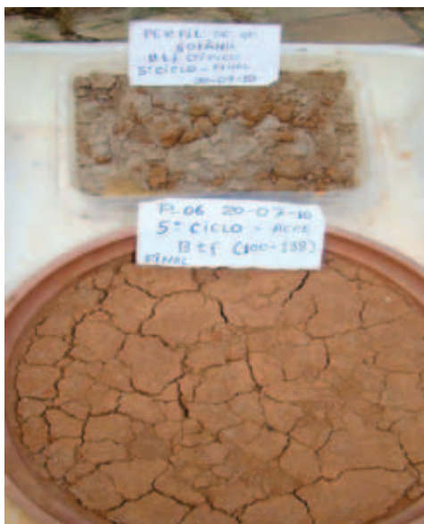
Figura 6. Aspecto da amostra de referência (Bandeja retangular superior) e da amostra do perfil AC-P06 (Bt2, 100-108 cm - Acre) (bandeja circular inferior) no final do quinto e último ciclo de umedecimento e secagem. Nota-se material plíntico (agregados com cor vermelha e estáveis > 2 mm) na amostra de referência e nenhum indício de plintita na amostra Bt2 (material esboroado e fendilhado com consistência macia).
