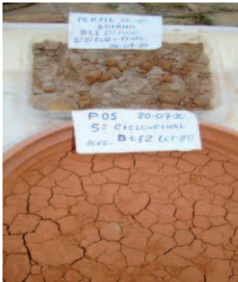
Figura 5. Aspecto da amostra de referência (bandeja retangular superior) e da amostra do perfil AC-P05 (Bt2, 67-87 cm) (bandeja circular inferior) no final do quinto e último ciclo de umedecimento e secagem. Nota-se material plíntico (agregados com cor vermelha e estáveis > 2 mm) na amostra de referência e nenhum indício de plintita na amostra Bt2 (material esboroado e fendilhado com consistência macia).
