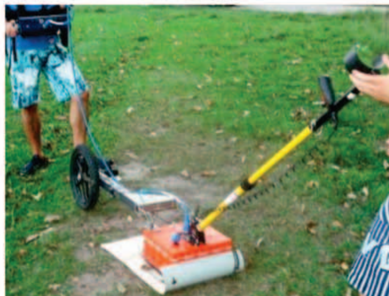
Figura 3. GPR sendo tracionado na área.
