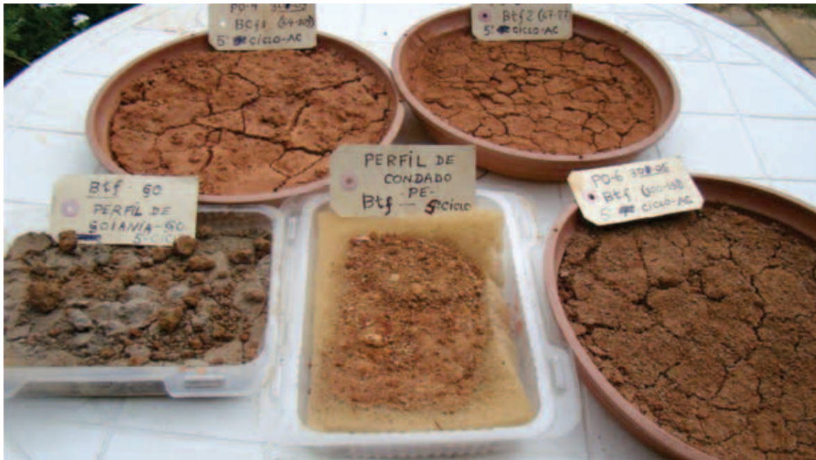
Figura 3. Aspecto geral das amostras no final do quinto e último ciclo de umedecimento e secagem. Nota-se material plíntico (agregados avermelhados estáveis > 2 mm) nas duas badeiras do canto esquerdo inferior que correspondem às amostras de referência.
