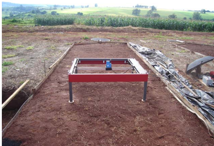
Figura 32: Equipamento rugosímetro a laser, posicionado na parcela experimental de erosão.
