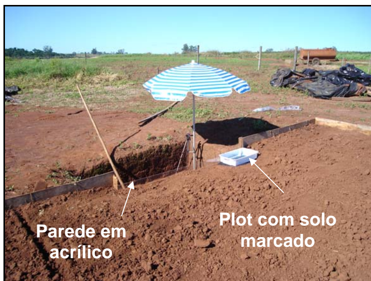
Figura 67: Parcela experimental com plot de solo marcado com azul de metileno
