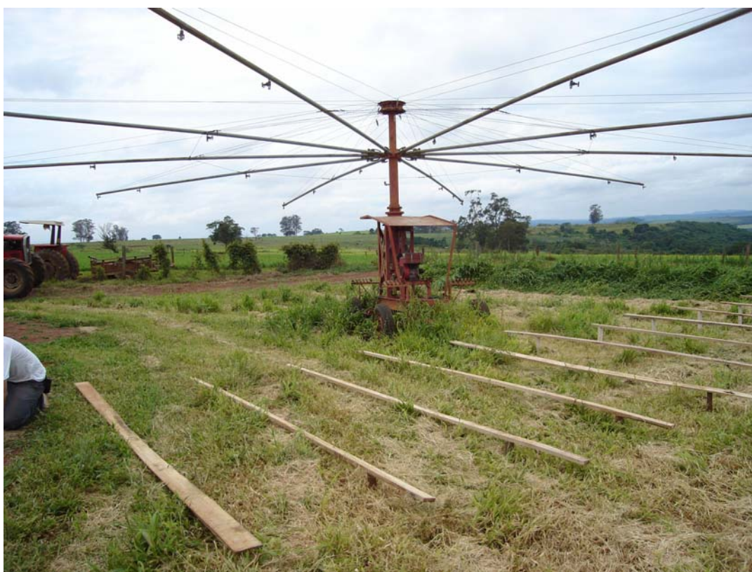
Figura 2: Suporte para os pluviômetros e posição do simulador durante a calibração
