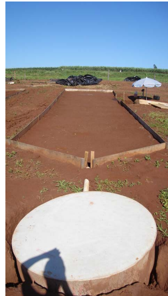
Figura 4: Par de parcelas padrão utilizadas nos ensaios. A direita observa-se a parcela padrão solo raspado. A esquerda observa-se a parcela padrão solo arado
