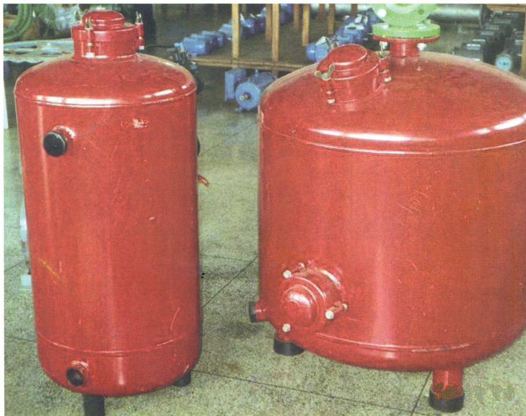
Figura 6. Filtros de areia.
