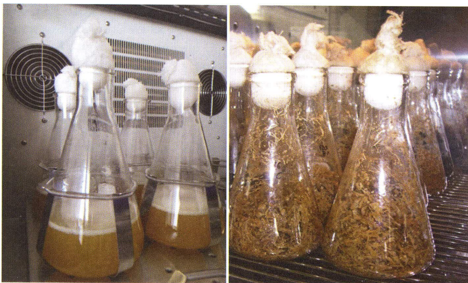
Figura 7. A. Fermentação submersa em escala de bancada. B. Fermentação no estado sólido em escala de bancada.
