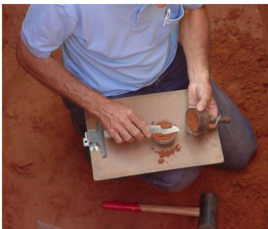
Figura 3.8 - Coleta de amostra com anel Kopeck para densidade de solo
