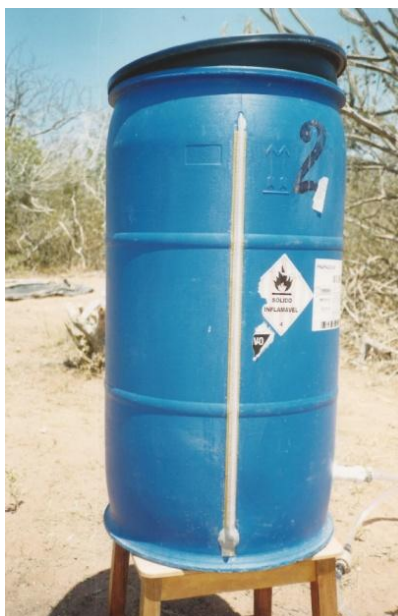
Figura 3.4 - Recipiente volumétrico com mangueira transparente, com escala milimétrica
