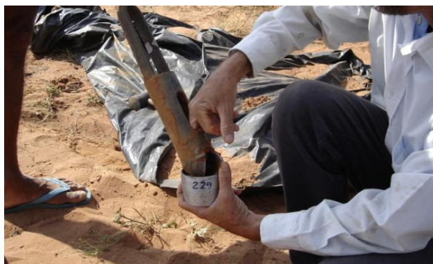
Figura 3.7 - Coleta de amostra de solo úmido em trado para capacidade de campo
