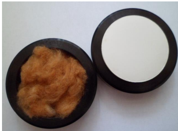
Figura 6: Célula de quartzo e tampa reflexiva para célula de quartzo. Foto: Germana Rosy M. de Sousa, Campina Grande, 2012.
