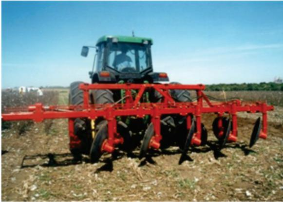
**Figura 1.** Arrancador de discos acoplado ao hidráulico do trator.
