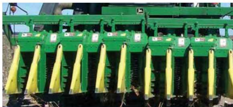
Figura 4. Colheitadeira John Deere, com sistema PRO-12 VRS (Foto: Ruy Yamaoka)
