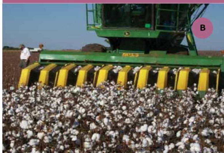
Figura 3. Colheitadeiras “stripper” de pente (A) e de escova (B) para algodão “Adensado” (Fotos: Emilio Pereira e Ruy Yamaoka)
