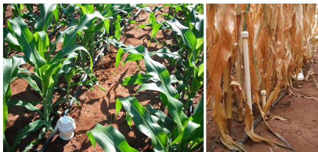
Figura 2. Sensores usados no monitoramento da umidade do solo, instalados em cada parcela de regime hídrico, sonda de capacitância Diviner 2000, com tubos de acesso de 1 m de profundidade (esquerda), e sensores de resistência elétrica, blocos de gesso modelo MEA2176 (Australiano), inseridos em tubos de PVC de ½ polegada de diâmetro (direita).
