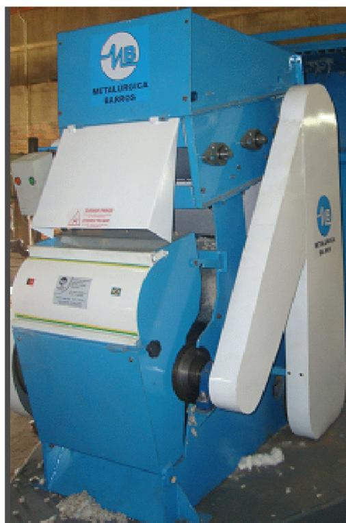
Figura 2. Limpador e descaroçador de 25 serras
