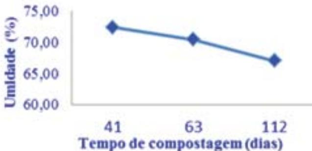
**Figura 3.** Umidade da leira de reviramento manual (RM) em função do tempo de compostagem.
