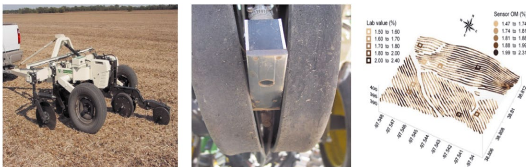
Figura 4: Sensor Óptico Veris para determinar materia orgánica de suelos
