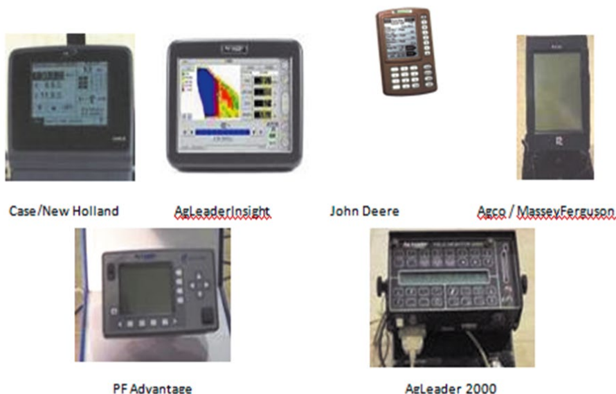
Figura 1: Monitores de rendimiento más difundidos
