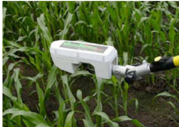
Figura 7. Un sensor manual “greenness” (intensidad del verde) usado para evaluar la salud actual del crecimiento del cultivo. Este sensor utiliza infrarrojo
