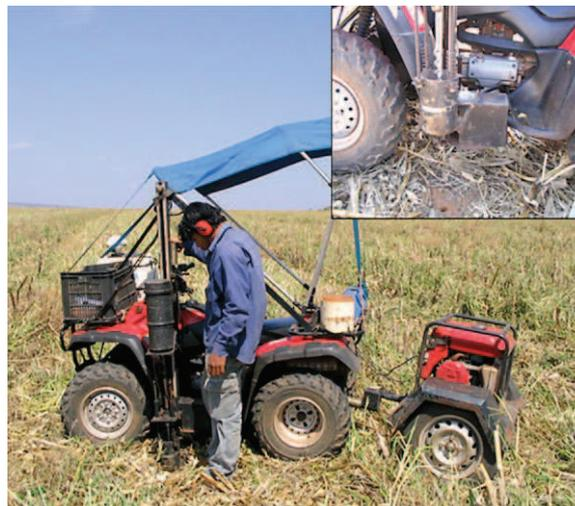
**Figura 4. Muestreador hidráulico tipo broca (foto pequeña) montado en cuatriciclo, equipo comúnmente utilizado en el muestreo georreferenciado del suelo. El GPS es el dispositivo de color blanco acoplado en frente del vehículo, al lado de la caja de almacenamiento de muestras. (Fotos: Álvaro Resende)**
