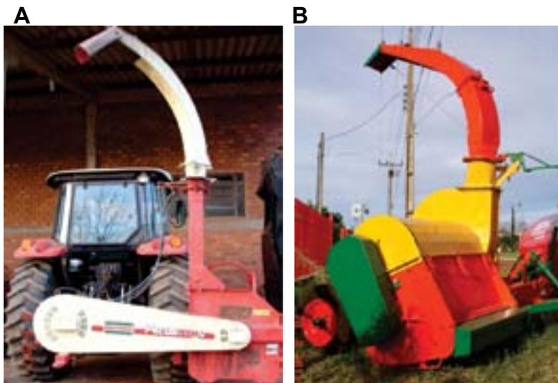
**Figura 14.10** A) Vista traseira de uma colhedora de forragem de precisão montada a um trator, observando-se o tubo de descarga com leme na extremidade; B) colhedora de forragem de duplo corte, com mecanismo repicador de disco.
