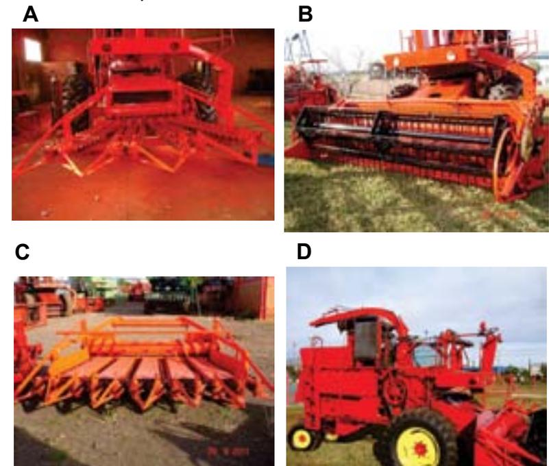
**Figura 14.13** A) Colhedora de forragem automotriz, adaptada para a colheita de silagem de milho ou sorgo, à partir de uma colhedora de grãos; B) plataforma para colheita de silagem de milho ou sorgo com espaçamento entrelinhas reduzido; C e D) colhedora de forragem para corte direto de plantas forrageiras de inverno.
