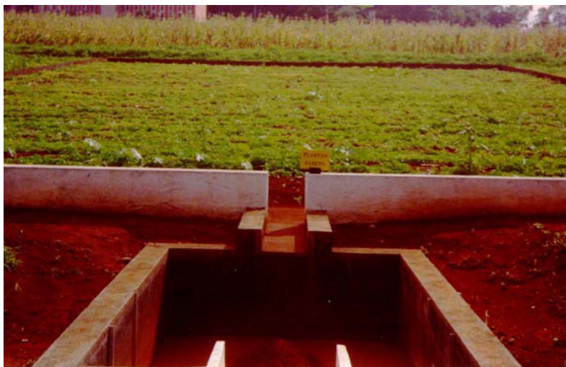
Figura 5. Vista em detalhe do coletor de água e sedimento após sua conclusão.
