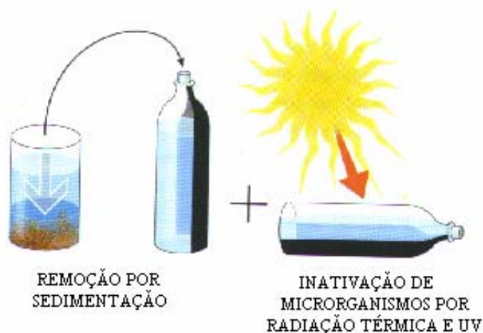
Figura 8. Esquema do método de desinfecção por radiação solar.
