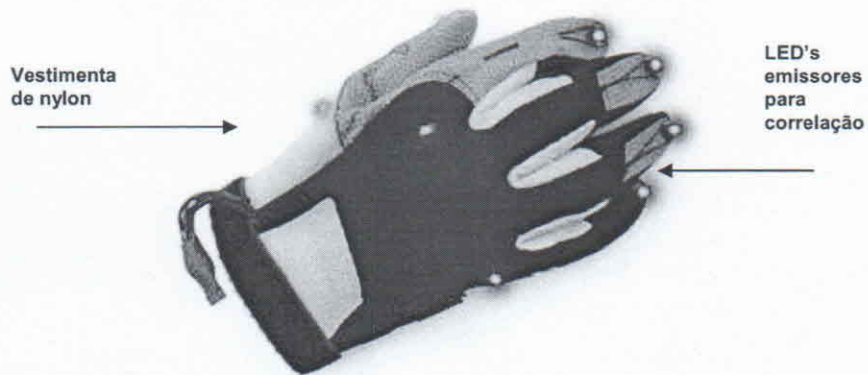
Figura 11. Impulse Glove com rastreamento óptico, que determina a posição por correlação de posições sob diversos emissores LED's (PhaseSpace, 2008)
